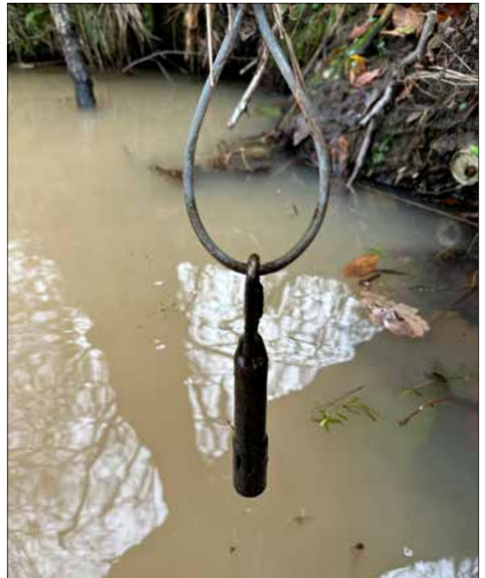
einer der installierten „Diver“ am Ritterbach, Foto: Bauamt
